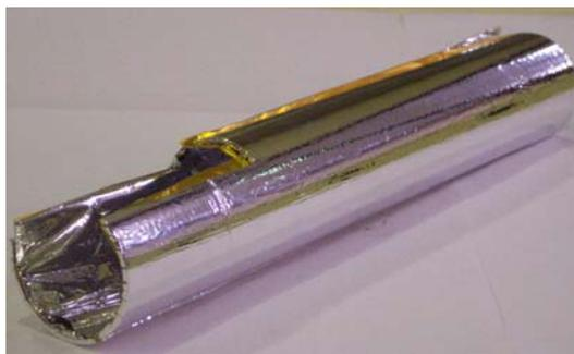
*Fig. 4 - Blindagem: Tubo de alumínio bipartido revestido com filme de baixa emissividade térmica e “Multilayer Insulation –MLI” de 15 camadas.*
