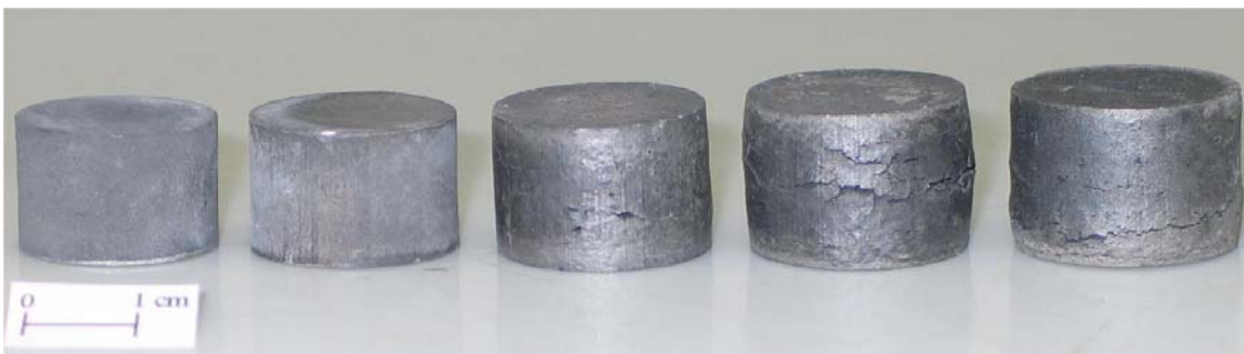
FIGURA 4.11- Alvos sinterizados a 1700°C de zircônia co-dopada com ítria e nióbia. Da esquerda para direita: 0%, 5%, 10%, 15% e 20% em peso de nióbia, todos os alvos com 8% em peso de ítria e massa aproximada de 20g.
