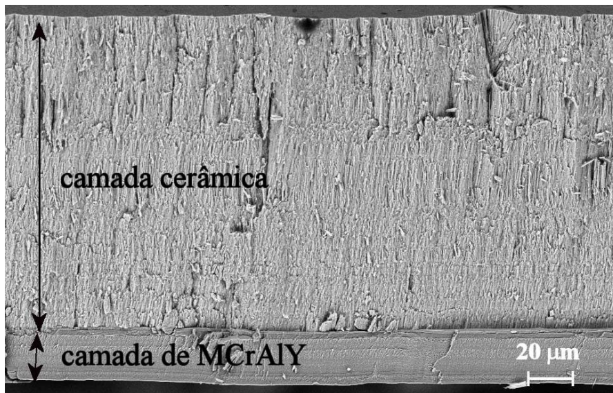
FIGURA 4.23 - Fotomicrografia obtida por MEV da seção transversal de um sistema destacado do substrato e fraturado.
