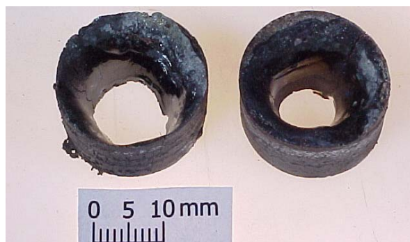
FIGURA 4.22 - Alvos cerâmicos em que ocorreram a formação de crateras.
