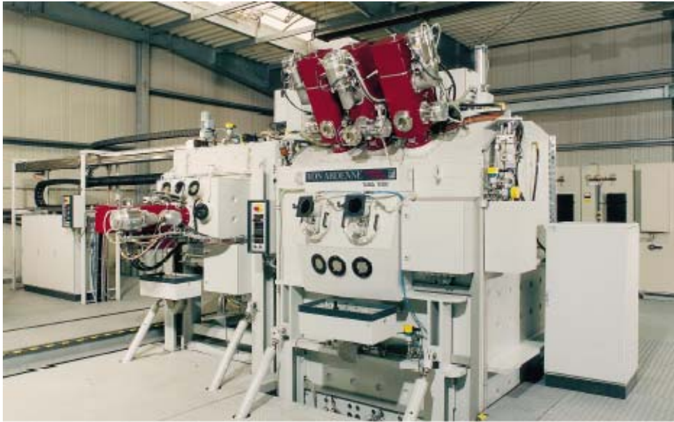
FIGURA 2.21 - Equipamento EB-PVD para produção de TBC. FONTE: [50].
