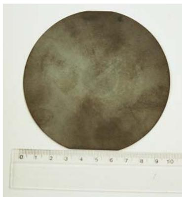
Fig. 5: Fotografia da amostra 3 de diamante *CVD* crescido por 24 horas.
