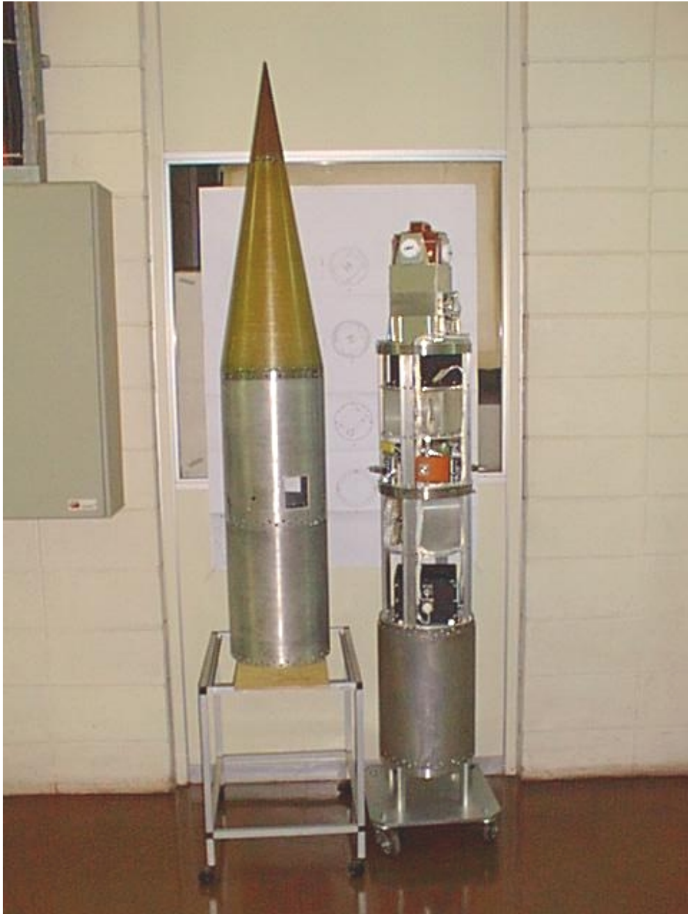
Fig. 16 - As baias de instrumentação da PSO, com a parte externa retirada.
