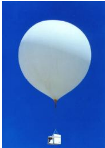
Fig. 11 – Trem de lançamento de radiossonda juntamente com sensor.
