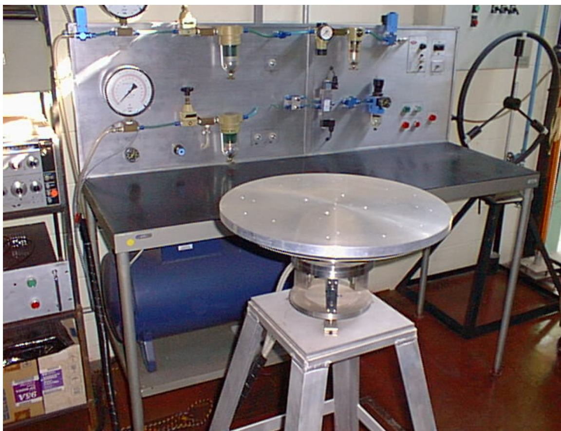
Fig. 5.6 - Mesa de Mancal a Ar de 1 Eixo e painel de alimentação e comando.
