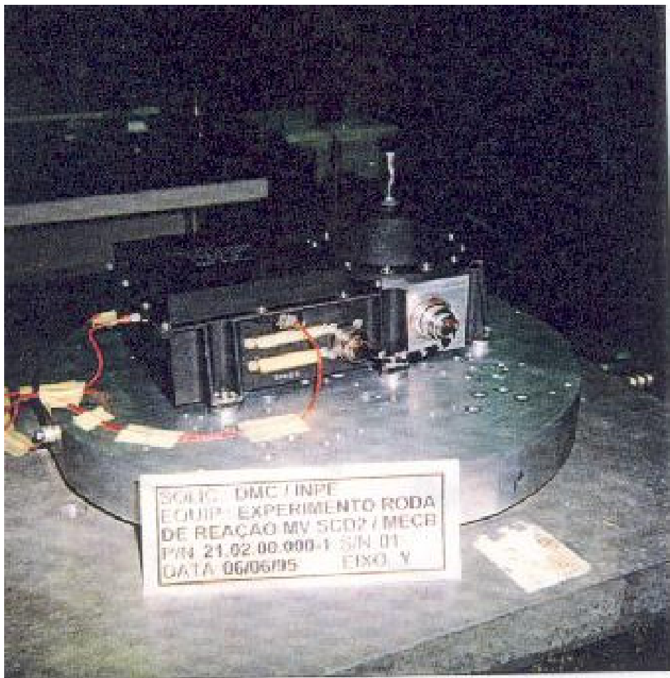
Fig. 3.6 - Foto do Experimento Roda de Reação em teste de vibração.
