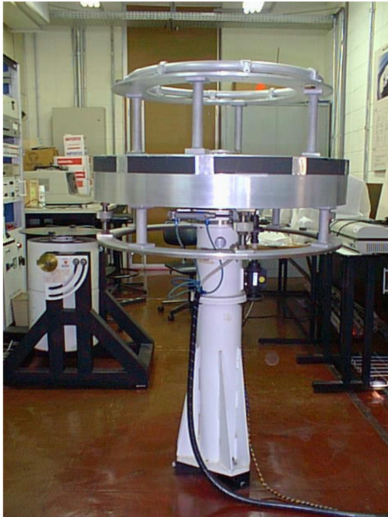
Fig. 5.8 – No primeiro plano, a Mesa de Mancal a Ar de 3 graus de liberdade com um amortecedor de natação montado para testes.
