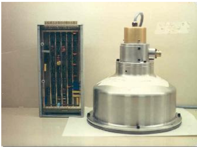
Fig. 5.9 - Foto do Modelo Experimental da Roda de Reação e de sua eletrônica.
