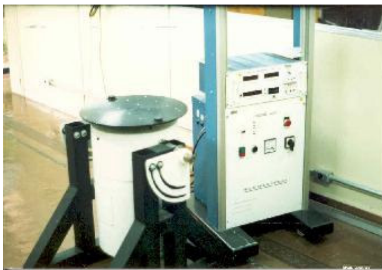
Fig. 5.2 - Foto da Mesa de Rotação Controlada e de seu rack de controle elétrico e eletrônico.
