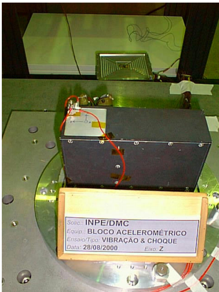
2.7 - Bloco Acelerométrico da PSO durante os testes de vibração em 08/2000.
