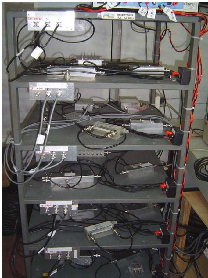
FIGURA 4.4 – Foto dos 5 receptores, entrada de 70 MHz e saída banda base de 2,5 MHz (seno e co-seno), instalados no rack dentro do container operacional.
