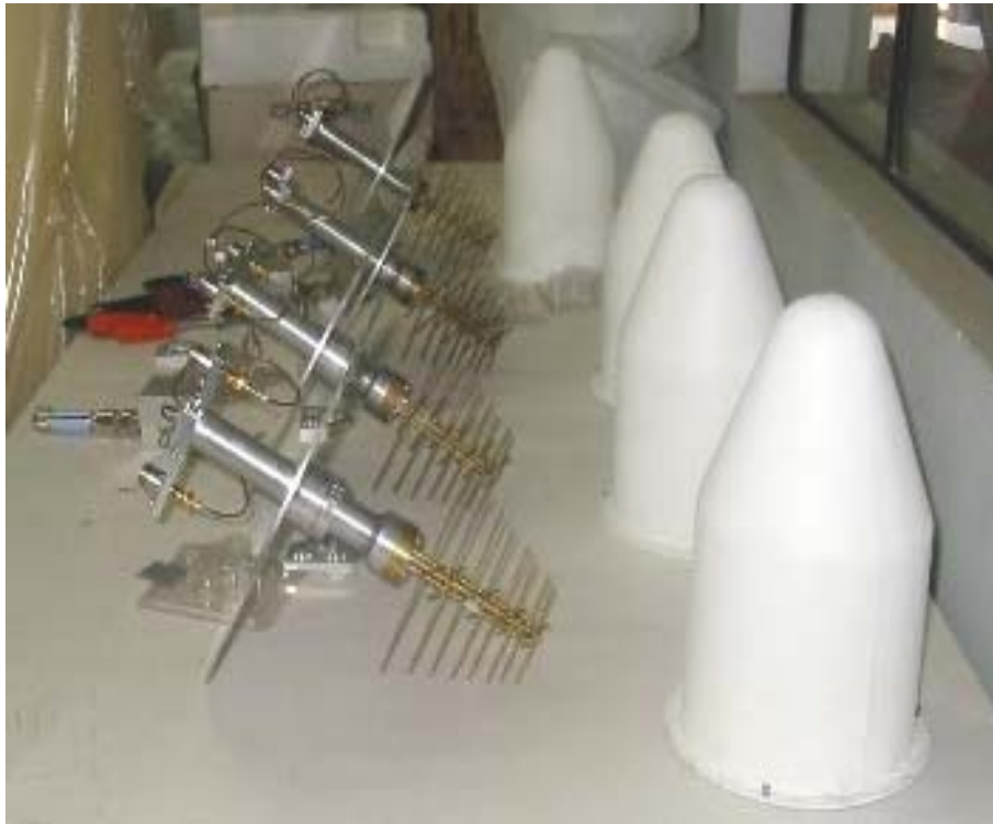
FIGURA 2.3 – Alimentadores fabricados e respectivas redomas.
