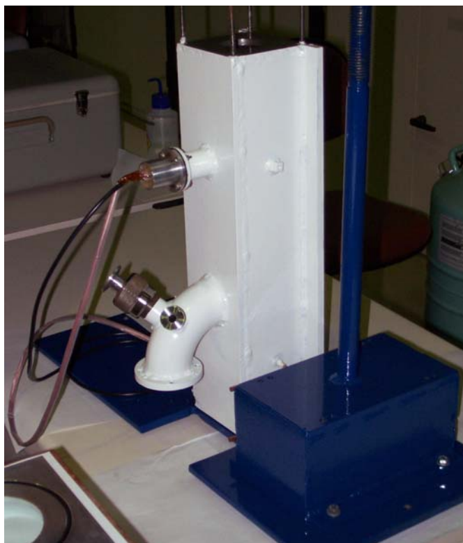
Fig. 8 - Vista posterior da câmara termovácuo. Detalhe das interfaces para o sistema de bombeamento e de aquisição de dados de temperatura e vácuo.
