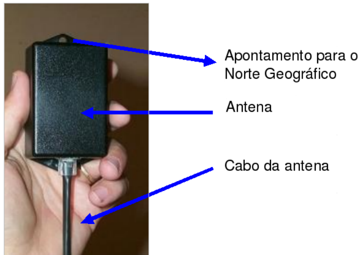
FIGURA 2.17 - Foto do Sensor Stormtracker
