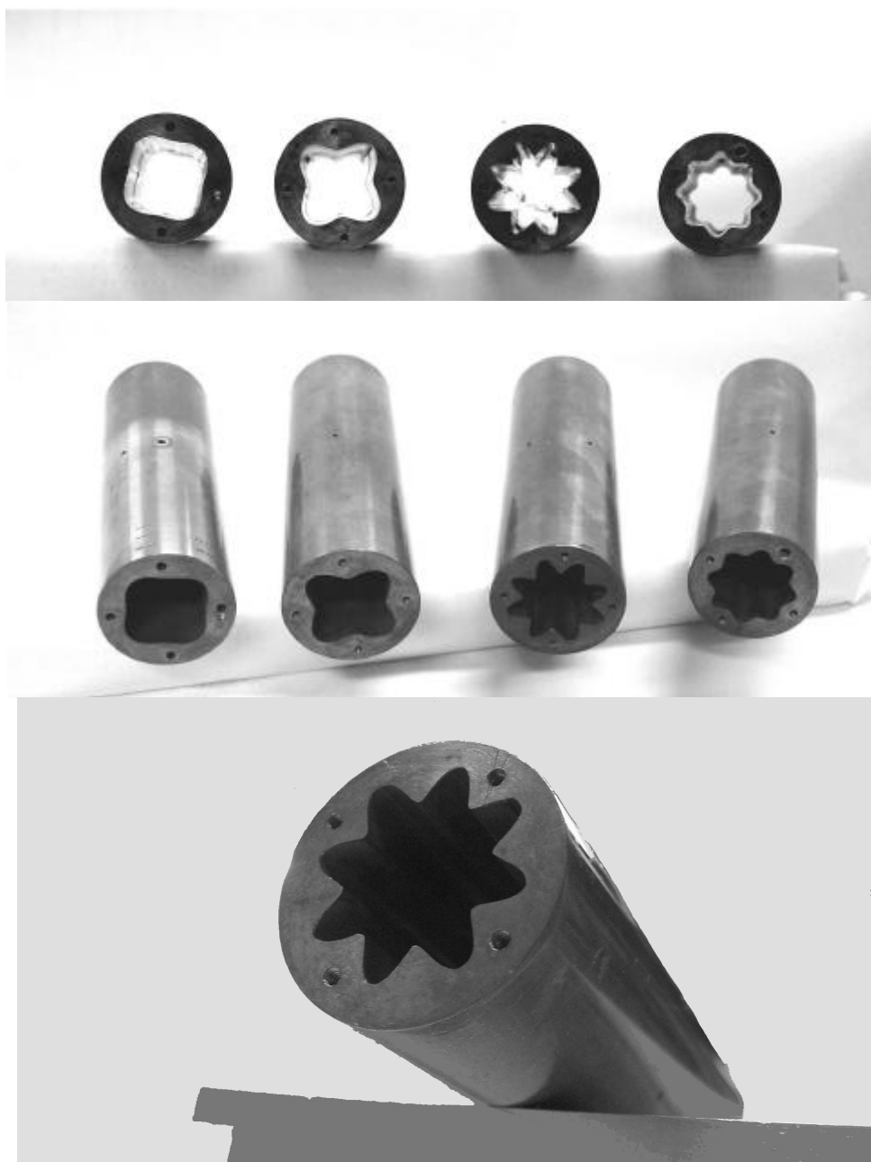
Fig. 3.1. Vistas dos ressoadores com corrugação transversa de perfil senoidal (o comprimento e o diâmetro externo dos cilindros são respectivamente 10,0 e 3,2 cm)
