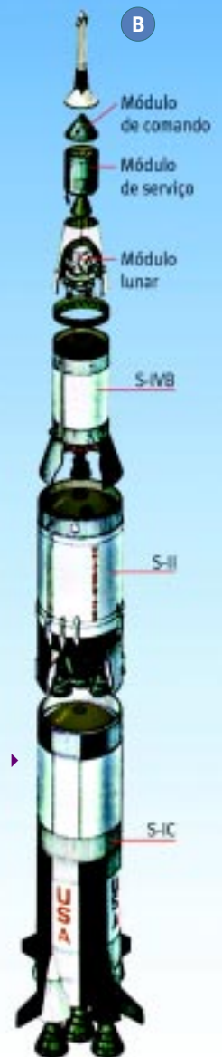
Figura 1. Em A, lançamento da Apollo 11, em 16 de julho de 1969, a bordo do foguete Saturno V, o mais poderoso veículo lançador espacial já construído pela humanidade. Em B, configuração de lançamento do foguete Saturno V para uma missão Apollo à Lua. Observe que o foguete propriamente dito se constitui de três módulos: S-IC, S-II e S-IVB. A nave Apollo, constituída dos módulos de comando e serviço, se acopla ao Saturno V acima da estrutura de armazenamento do módulo lunar
