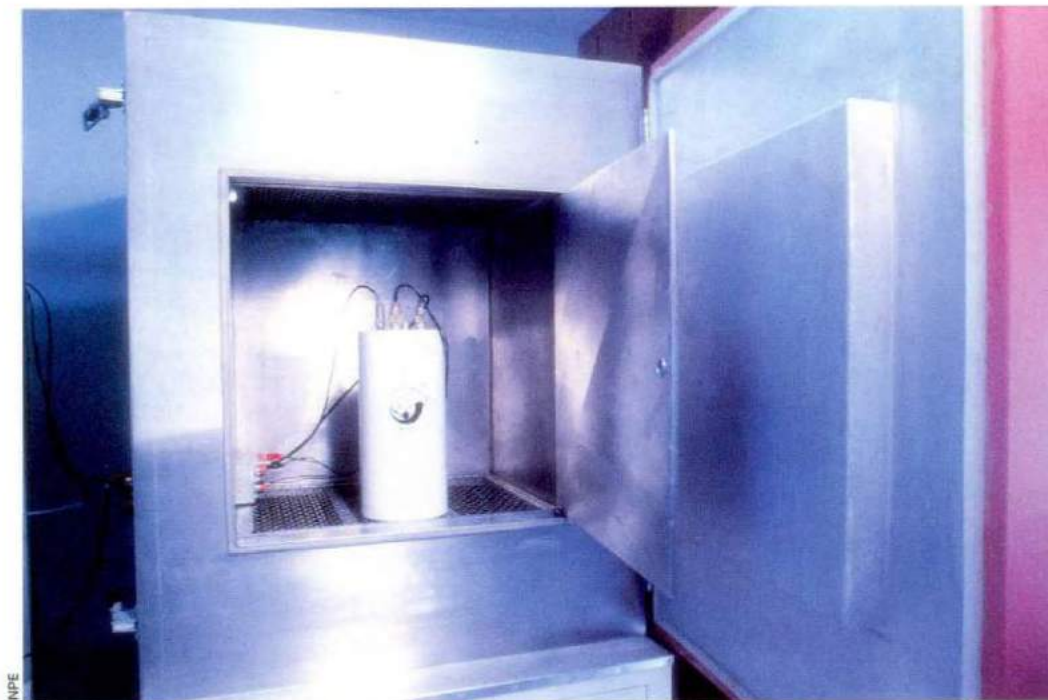
Plataforma de coleta de dados em testes no INPE, em Natal, RN. Data Collection Platform under test at INPE, Natal, Rio Grande do Norte.
