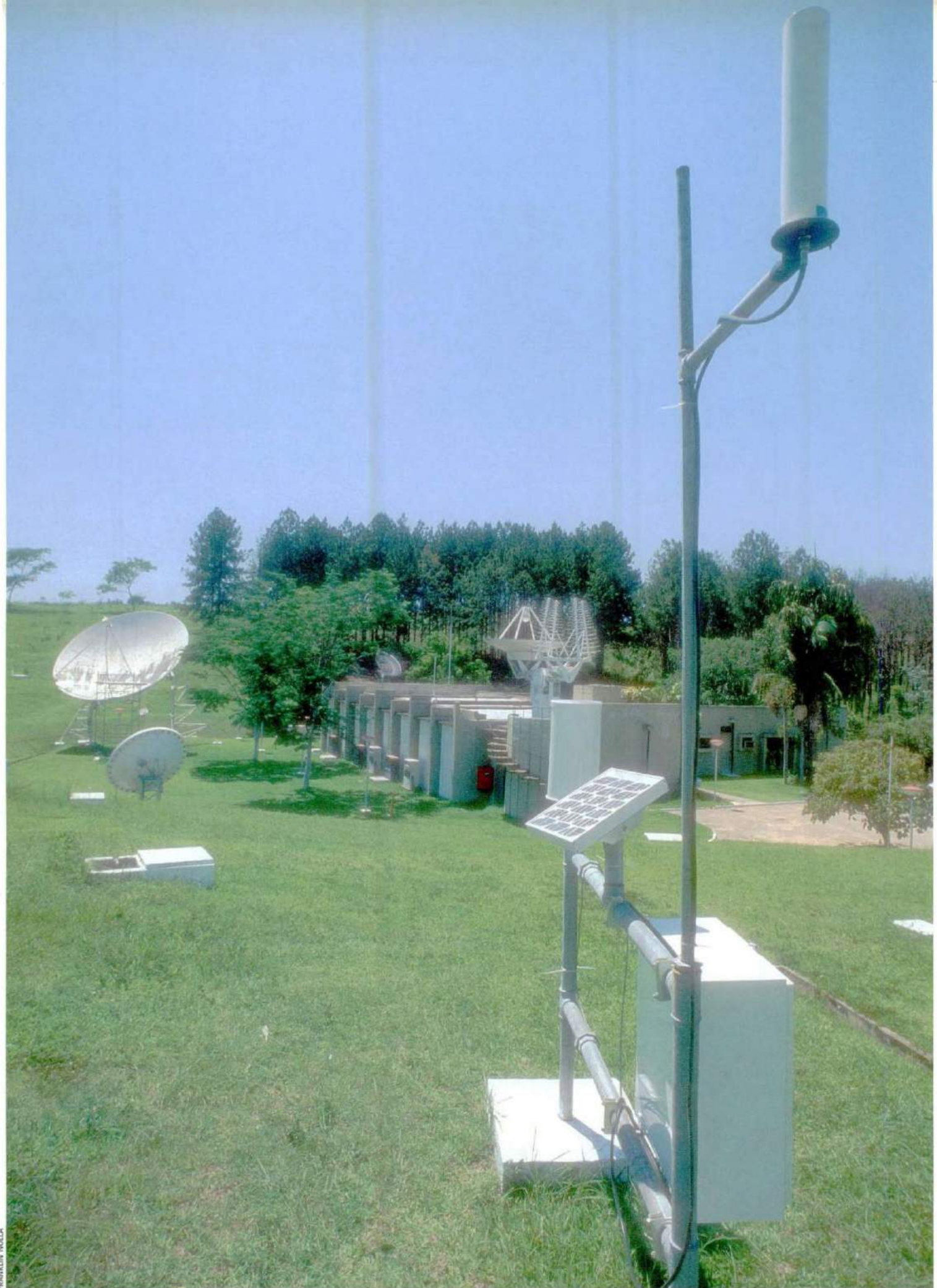
Plataforma de Coleta de Dados (PCD) instalada no INPE, Cachoeira Paulista. Ao fundo, antenas para recepção de satélites meteorológicos. Data collection platform installed at INPE, Cachoeira Paulista. In the background, antenna for data reception from meteorological satellites.
