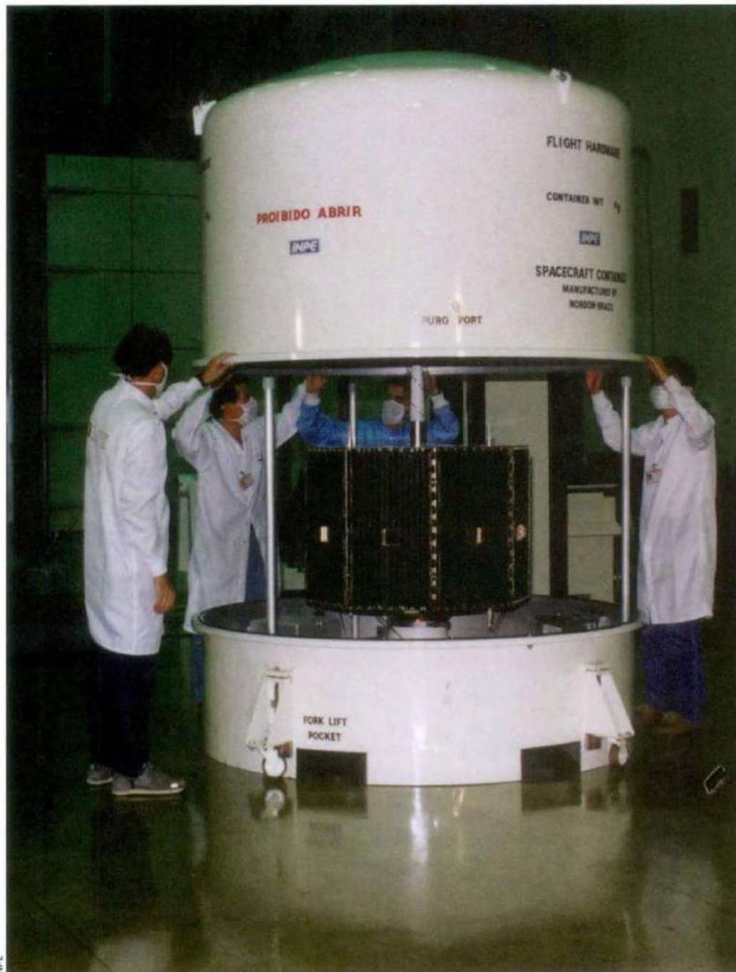
Técnicos do LIT embalam o SCD-1 no container em que foi embarcado para os EUA, em dezembro de 1992. LIT technicians packing the SCD-1 satellite in the container in which it was shipped to the USA in December 1992.
