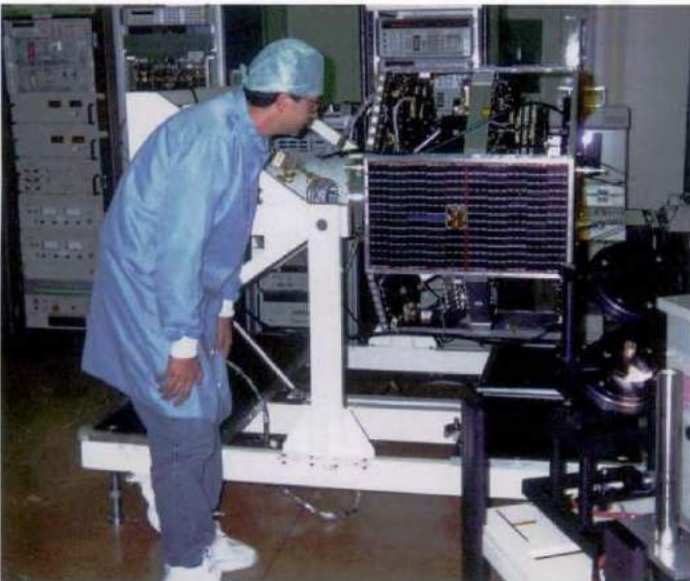
Experimento célula solar integrado ao Satélite de Coleta de Dados 2 - SCD-2. Solar cell experiment integrated in the Data Collection Satellite 2, SCD-2.
