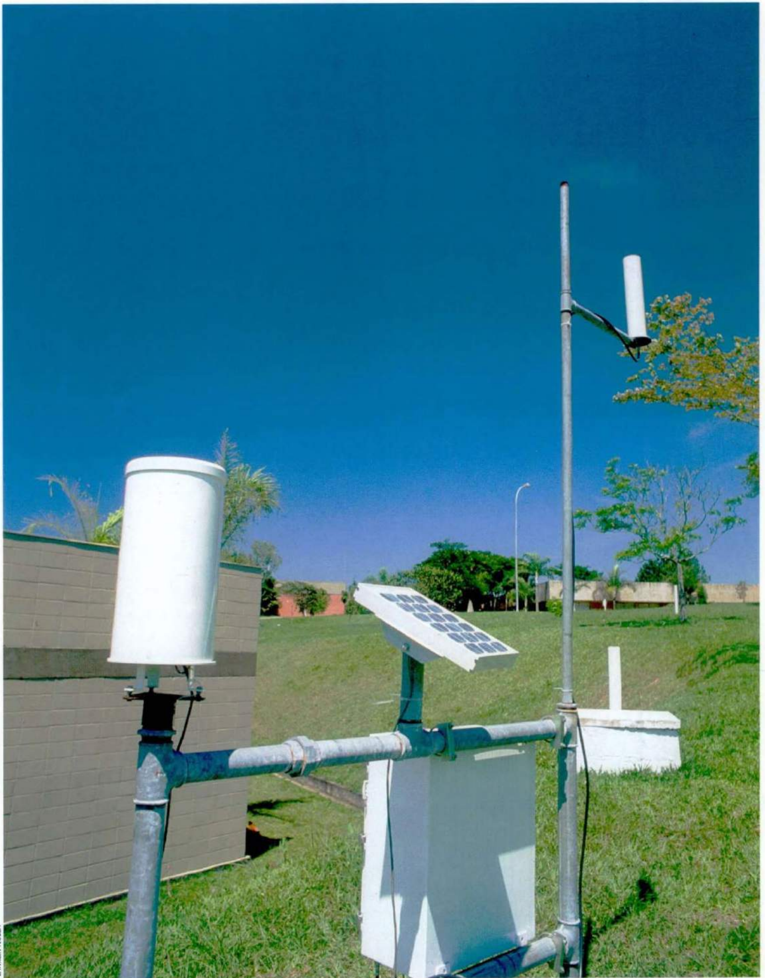
Plataforma de Coleta de Dados (PCD) instalada no INPE, em Cachoeira Paulista (SP). Data Collection Platform installed at INPE, Cachoeira Paulista, in the state of São Paulo.
