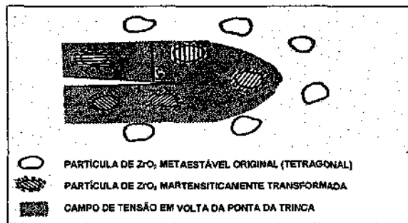
Figura 3 Representação esquemática do campo de tensão criado na microestrutura da cerâmica decorrente da transformação induzida de fase de partículas de zircônia tetragonal metaestável para monoclinica [1,19]
