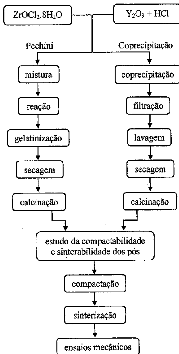
Figura 6 Fluxograma mostrando as etapas de processamento para a obtenção das cerâmicas propostas neste projeto de tese
