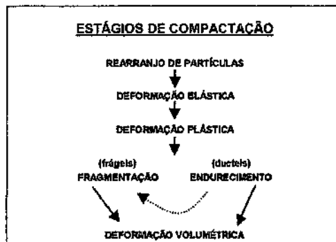
Figura 4 Fluxograma do processo de compactação por prensagem, mostrando as diferenças nos comportamentos dos pós dúcteis e frágeis [32]
