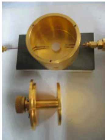
FIGURA 8 - Vista da caixa de teste blindada para determinar a frequência de ressonância.
