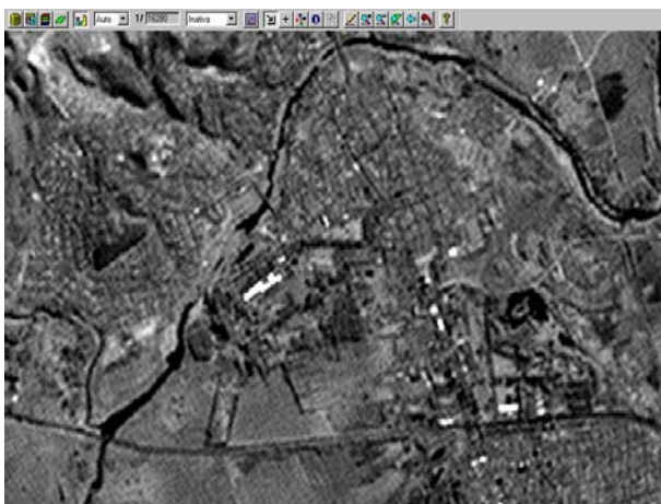
FIGURA 3.21 - Imagen LANDSAT-7/ETM+ banda 8 con restauro de píxel de 5 m., aplicado filtro “Passa Baixa-Média con máscara 3x3” y luego realce de Contraste Lineal. Escala 1:15 000.
