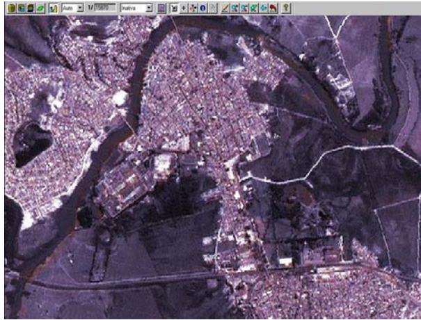
FIGURA 3.18 - Imagen CBERS-2 234 con restauro de 10 m.; y, SPOT-IV banda pancromática con restauro de 5 m. con realce de Contraste Lineal. Escala 1:15 000.
