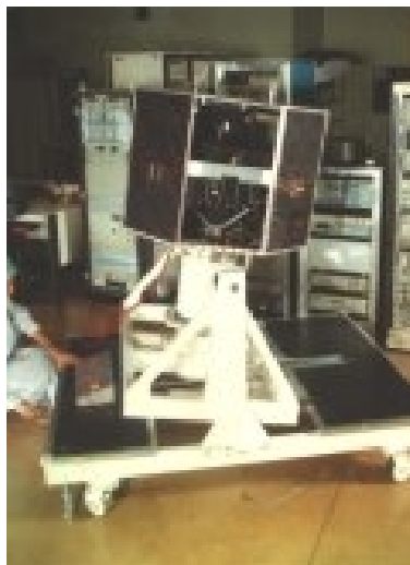
Fig. 15 – Satélite SCD-1 em configuração de Teste Funcional. FONTE: LIT/INPE
