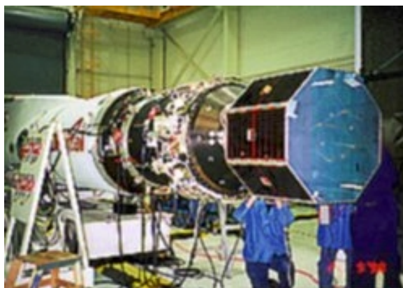
Fig. 34 - Integração do satélite SCD-2 com o veículo lançador. FONTE: LIT/INPE
