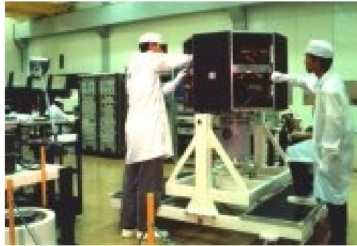
Fig. 12 - Integração elétrica do satélite SCD-2. FONTE: LIT/INPE
