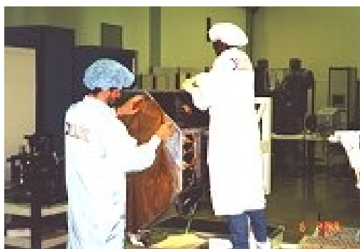
Fig. 11 - Montagem mecânica do satélite SCD-2 FONTE: LIT/INPE
