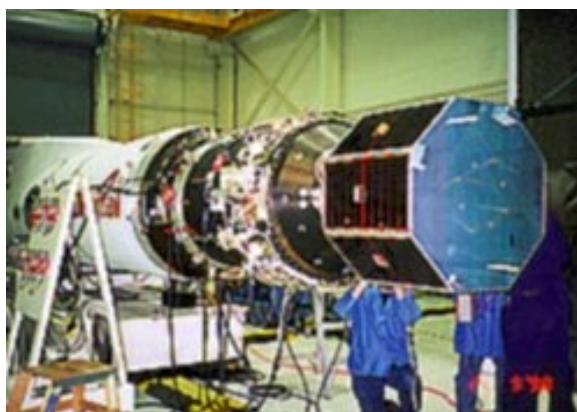
Fig. 35 - Verificação funcional e teste de compatibilidade entre o satélite SCD-2 e o veículo lançador. FONTE: LIT/INPE
