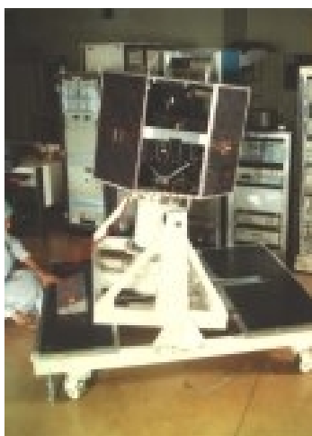
Fig. 23 – Satélite SCD-1 em configuração de Teste Funcional FONTE: LIT/INPE
