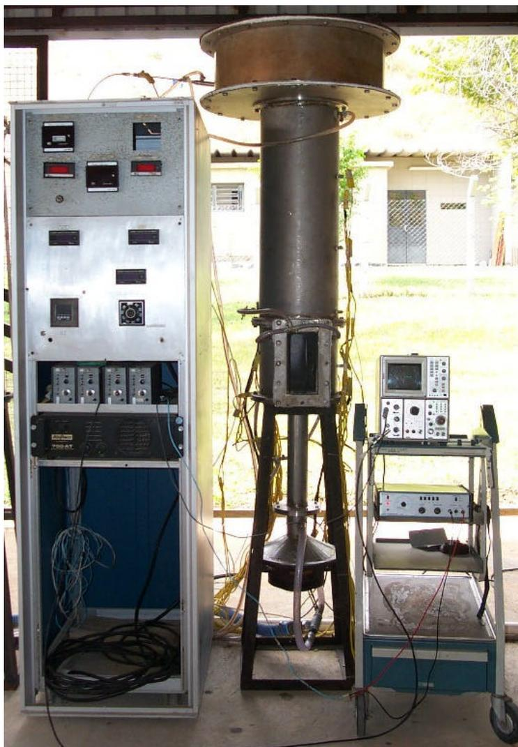
FIGURA 2.2 – Câmara de combustão com o queimador e o sistema de atuação acústica.
