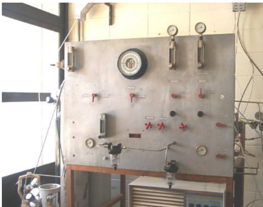
FIGURA 2.8 – Painel da linha dos gases dos analisadores.
