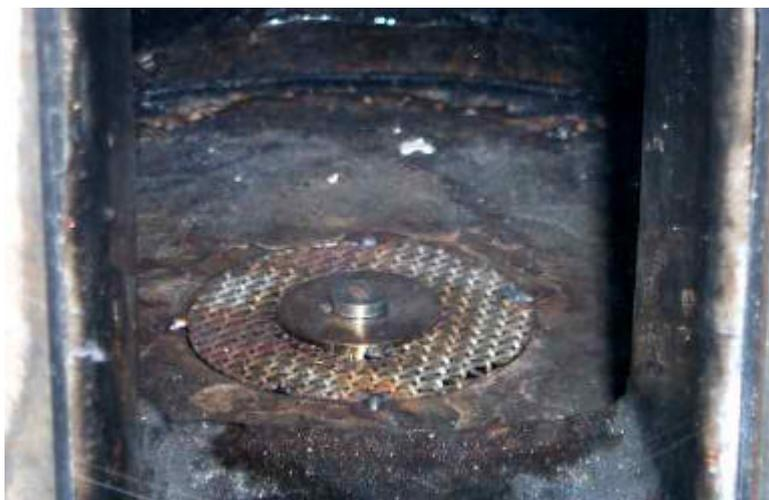
FIGURA 2.4 – Detalhe da saída do queimador no interior do Combustor.
