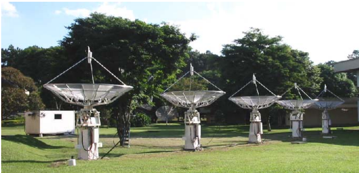
FIGURA 1.1 – Protótipo de 5 antenas do BDA no INPE-SJC. Ao fundo, a sala de controle (container).
