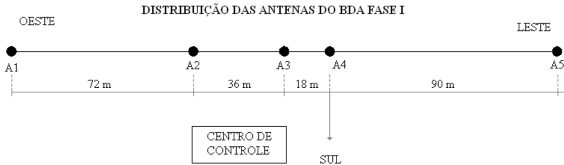
FIGURA 6.1 – Plano da localização das antenas para o PBDA, em Cachoeira Paulista, SP.
