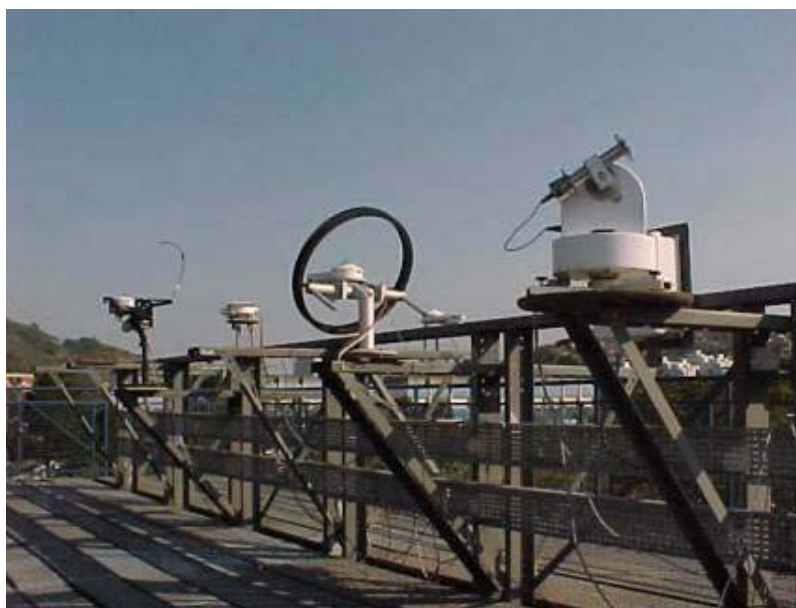
FIGURA 3.2 - BSRN Florianópolis – SC Bancada de instrumentos de medição solar visto na da foto: (A) Pirheliômetro de cavidade absoluta, visto a direita da foto; (B) Piranômetro com anel de sombreamento logo após o Pirheliômetro.
