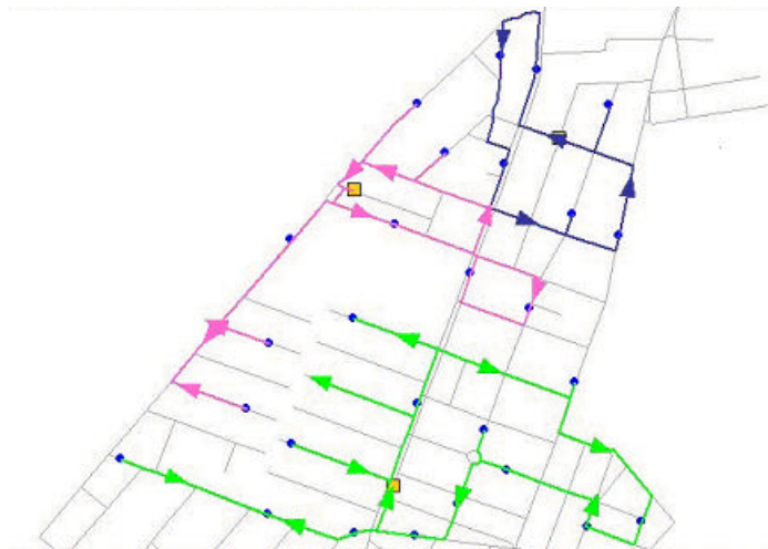
Figura 7: Rotas para 3 caminhões (considerando capacidades)
