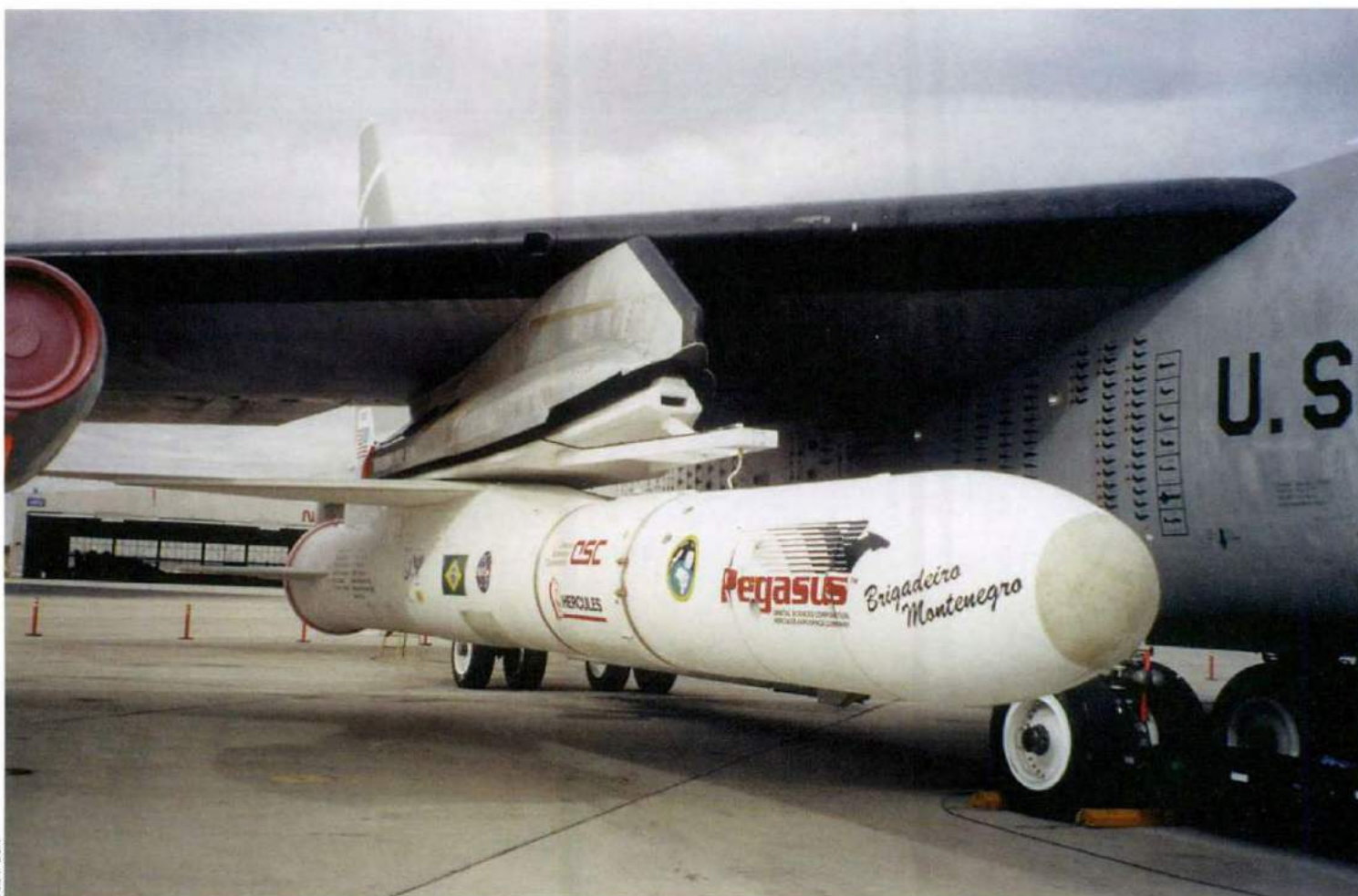
O SCD-1 instalado na ogiva do Pegasus, que recebeu o nome de Brigadeiro Montenegro. The SCD-1 satellite installed in the nose cone of the Pegasus rocket, "Brigadeiro Montenegro".
