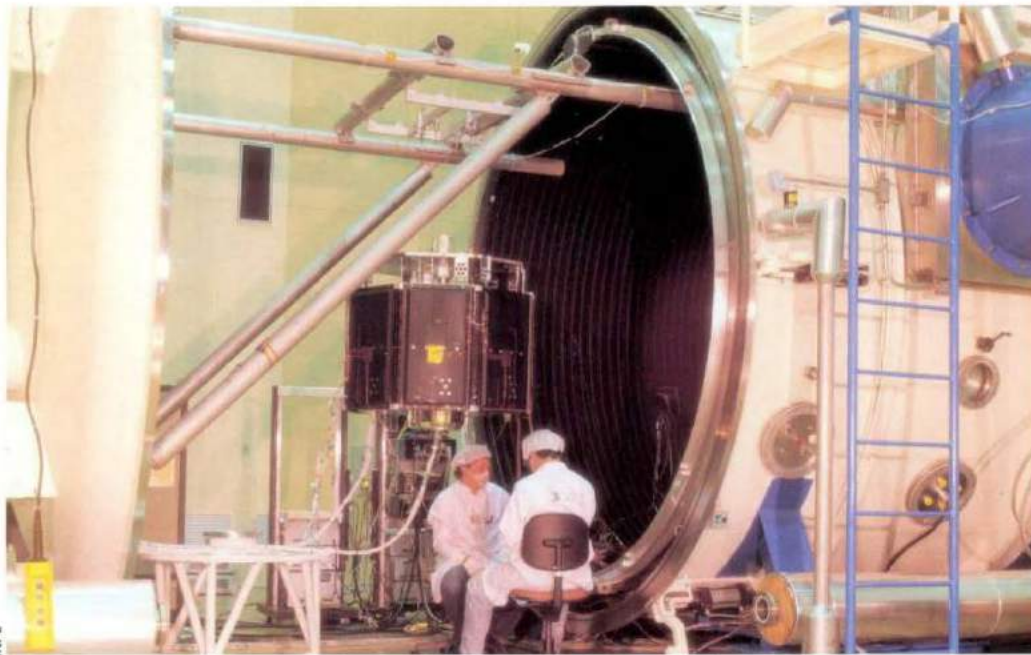
O modelo térmico do SCD-1 em testes na câmara termovácuo, em 1988. Thermal model of the SCD-1 satellite under test in a thermal vacuum chamber in 1988.
