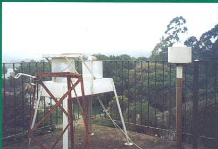
Fig. 6 Fotografia do coletor tipo 'wet-only' (marca MTX Itália) instalado sobre a caixa d'água do Instituto de Astronomia, Geofísica e Ciências Atmosféricas (Foto M.C. Forti).
