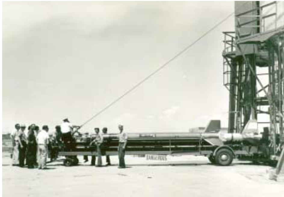
Figura 5.2 - Foguete AEROBEE 150 já no trilho do lançador, inclusive com o “booster” a propelente sólido devidamente incorporado. Passo seguinte, é colocá-lo na posição vertical para receber os propelentes. A foto, feita em White Sands Missile Range, New Mexico, aparece o oficial de segurança apresentando o foguete para alguns alunos, entre os quais o autor.
