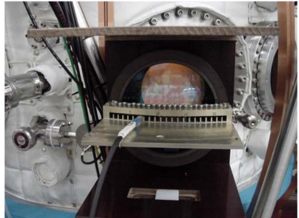
Figura 17. Lente coletora do sistema de espalhamento Thomson.
