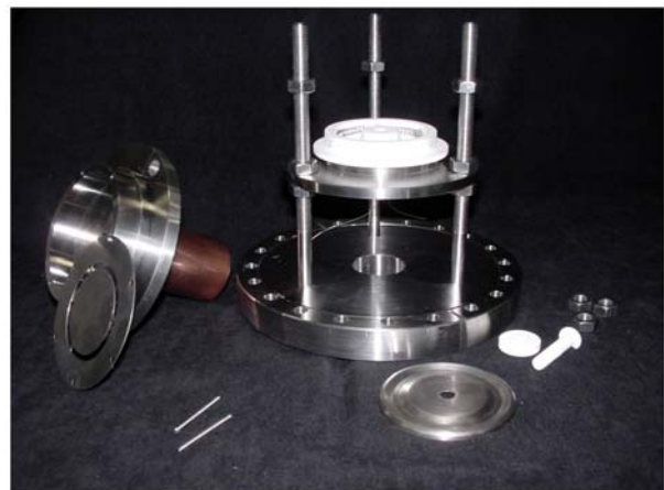
Figura 26. Canhão eletrônico melhorado.
