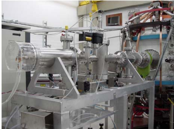
Figura 20. Sonda por feixe de lítio neutro acoplada ao tokamak ETE.
