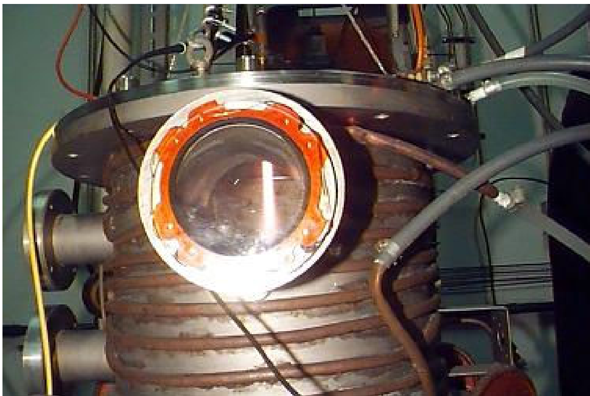
Figura 5: Tocha de plasma em funcionamento
