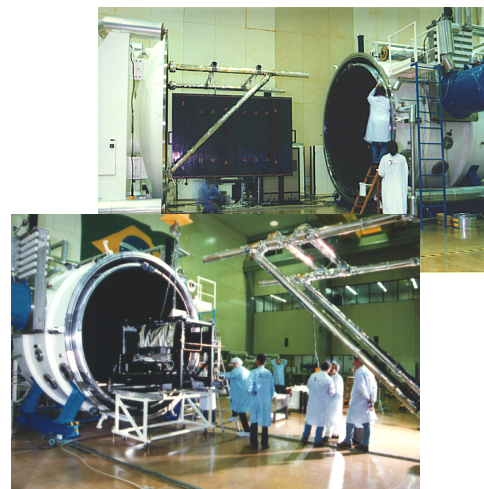
Figura 1 – Diferentes sistemas espaciais durante a etapa de qualificação : teste termo-vácuo
